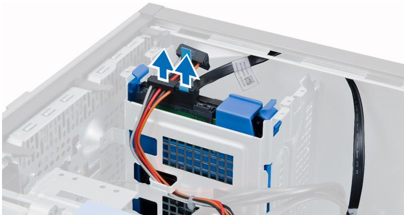
4. Premere le linguette di fissaggio verso l'interno ed estrarre il supporto del disco rigido dall'alloggiamento per unità.
