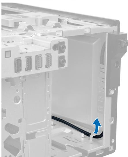
5. Premere i fermagli su entrambi i lati dell'interruttore di alimentazione per sbloccarlo dal telaio ed estrarlo dal computer. Estrarre l'interruttore di alimentazione, con il relativo cavo, dalla parte anteriore del computer.
